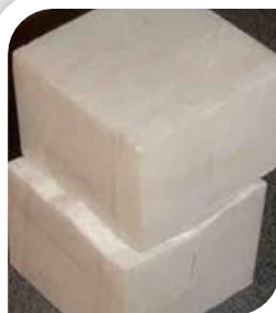
Joint lisse du marbre de Pentelikon
