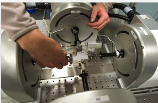
Mise en place d'une éprouvette de textile
