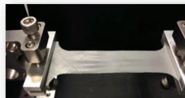
Séchage d'un film de microfibrilles de cellulose
