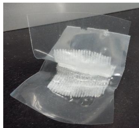
Films de LD-PE soudés à l'aide de la soudeuse à ultrasons
