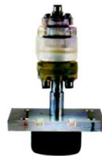
Cellule retention eau Contrôle de succion et pression d'air Echantillon: \Phi = 10\text{mm} h = 10\text{mm}
