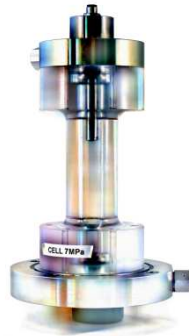
Cellule triaxiale roches \sigma_3 \text{ max} = 7000 \text{ kPa} Echantillon: \Phi=11\text{mm} h=22\text{mm}
