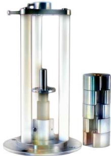
Cellule oedométrique poudres \sigma_1 \text{ max} = 300 \text{ kPa} Echantillon: \Phi = 20\text{mm} h = 30\text{mm}
