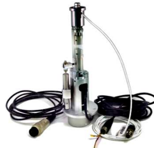
Cellules Traction / Compression, Contrôle Humidité et Température 5-50 et 50-500N Echantillon: \Phi = \sim 20\text{mm} h = \sim 20\text{mm}
