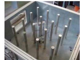
*Inclusions et instrumentation dans la cuve avant remplissage des matériaux*
