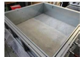
*Cuve après mise en place de la nappe géosynthétique et du cadre contenant le matelas*
