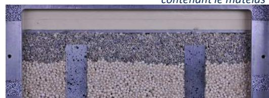
*Massif à travers la fenêtre latérale : matelas granulaire de 50 mm d'épaisseur sous un dallage rigide*
