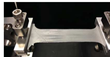
Séchage d'un film de microfibrilles de cellulose
