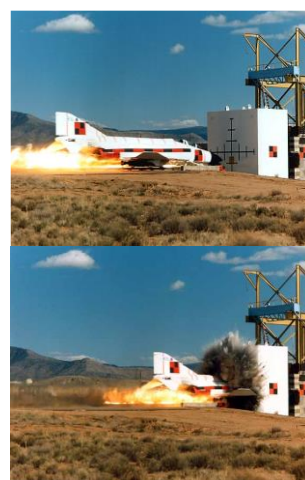
F4 Phantom lancé à 774 km/h sur un mur en béton de 3,66m d'épaisseur (Sandia National Laboratories)
