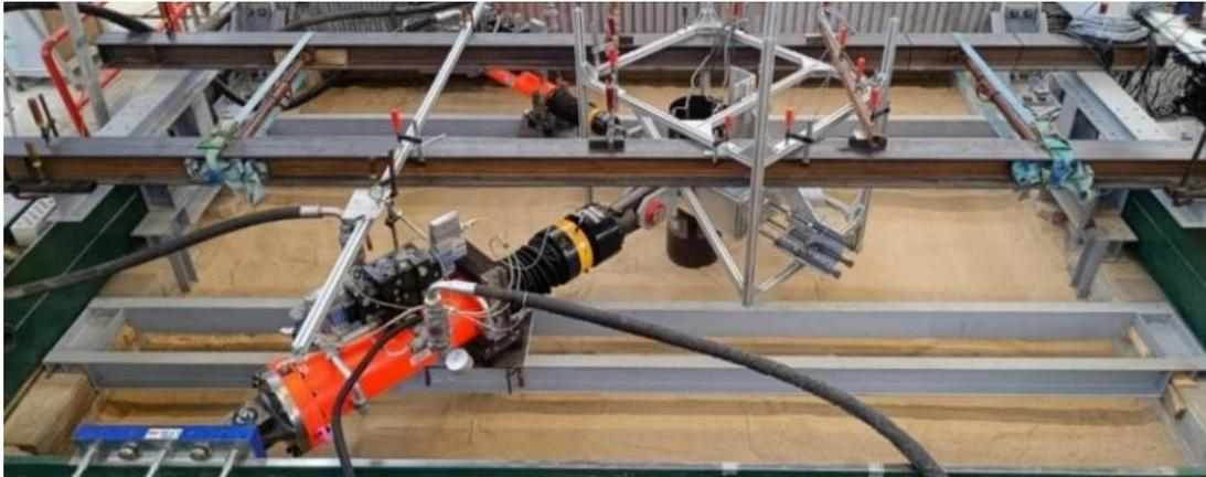
Figure 1. Installation expérimentale pour l'essai de chargement multidirectionnel (TU Darmstadt) / *Experimental installation for the multidirectional loading test (TU Darmstadt).*
